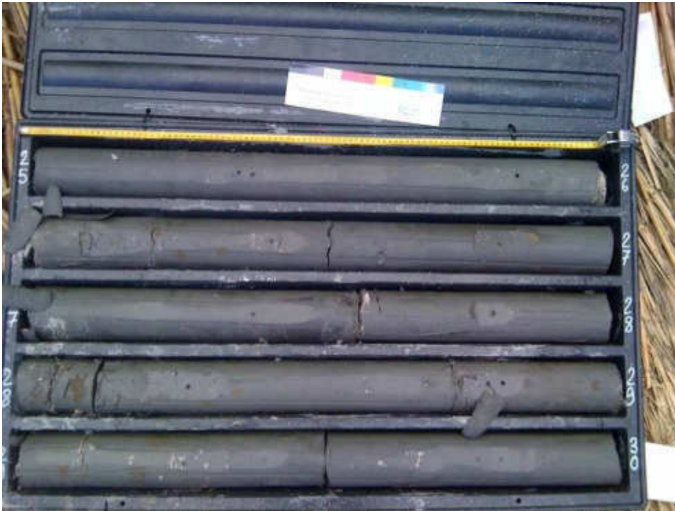
Sondaggio S2, cassetta n.6 (25,00-30,00 metri)
