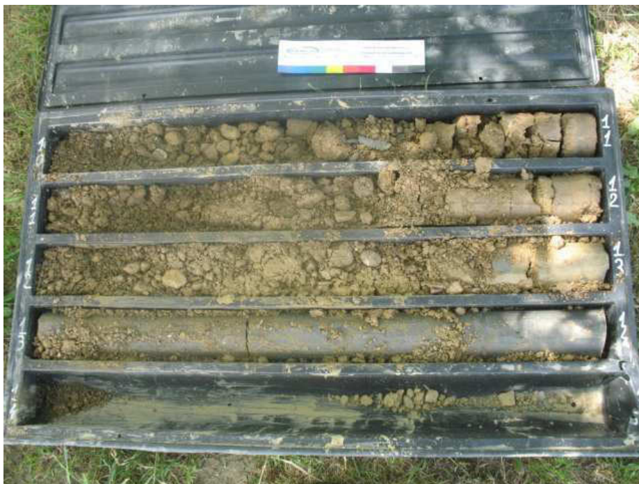
Sondaggio S5, cassetta n.3 (10,00-15,00 metri)
