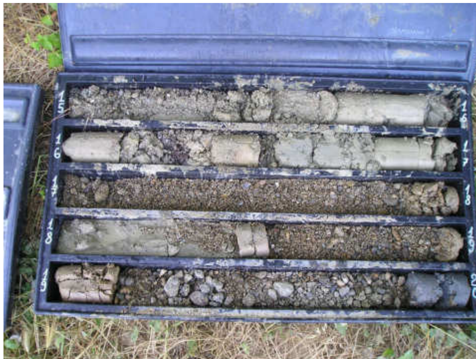
Sondaggio S1, cassetta n.4 (15,00-20,00 metri)
