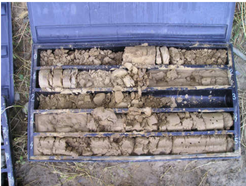
Sondaggio S1, cassetta n.1 (0,00-5,00 metri)
