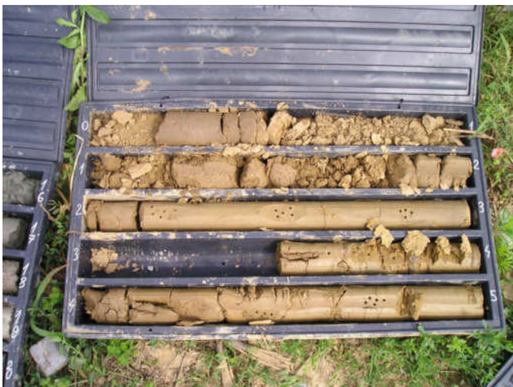
Sondaggio S6, cassetta n.1 (0,00-5,00 metri)
