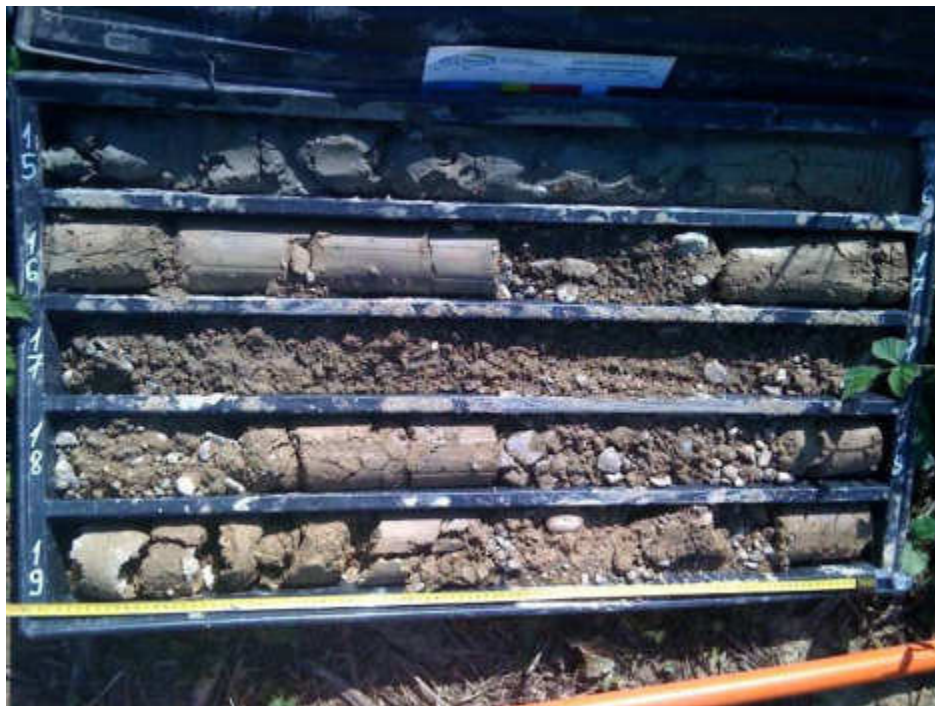
Sondaggio S3, cassetta n.4 (15,00-20,00 metri)
