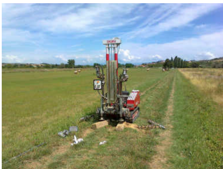
Strumentazione su postazione CPT1
