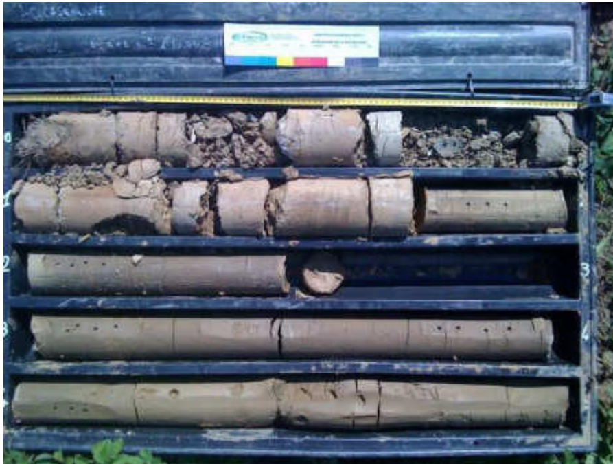
Sondaggio S3, cassetta n.1 (0,00-5,00 metri)
