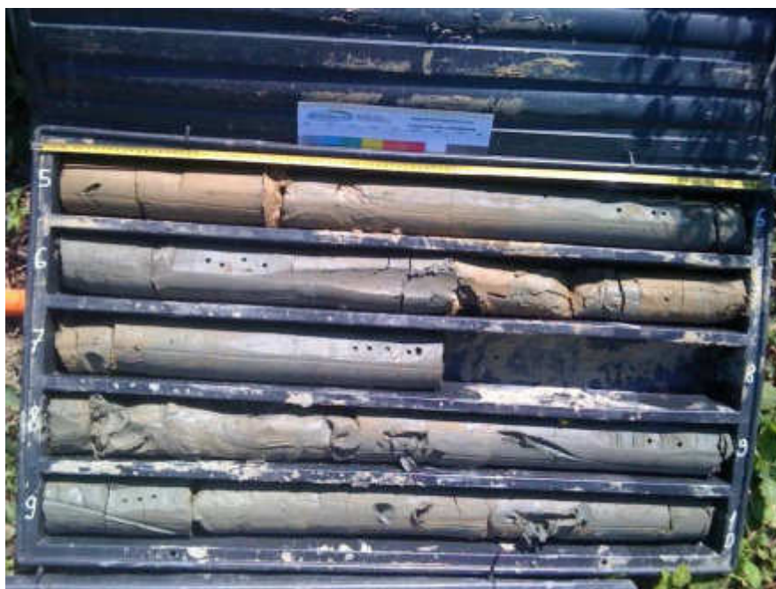
Sondaggio S3, cassetta n.2 (5,00-10,00 metri)
