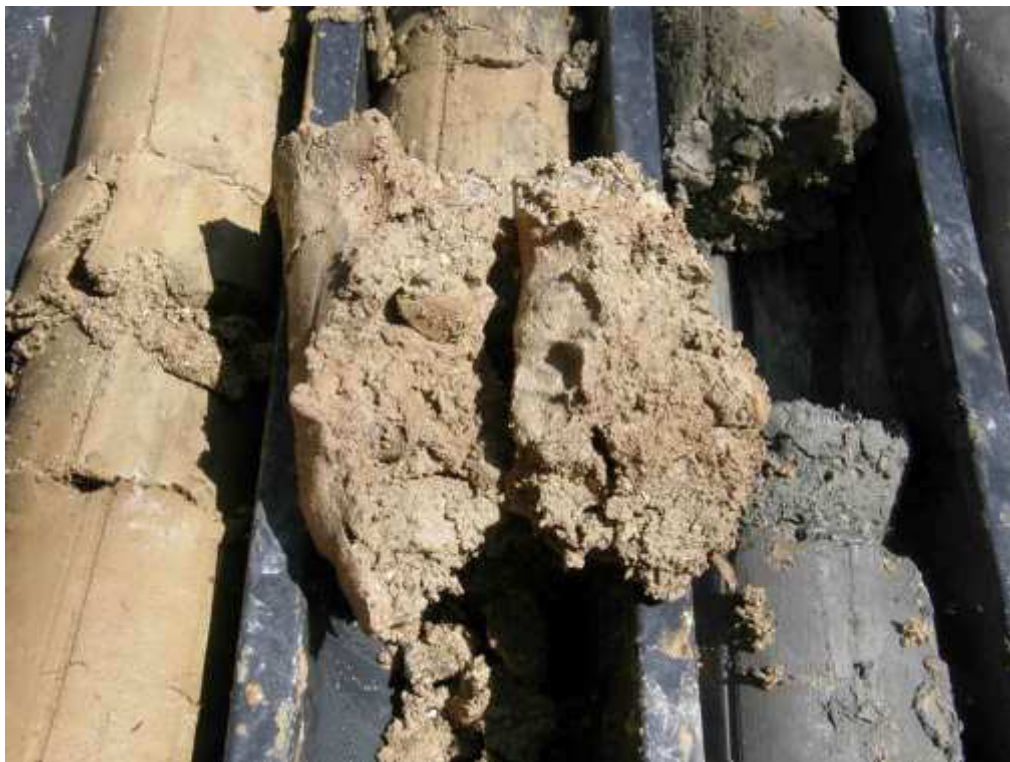
Foto 1. Depositi alluvionali dell'Elsa. Facies sabbioso limosa con ciottoli (riferimento sondaggio S2)
