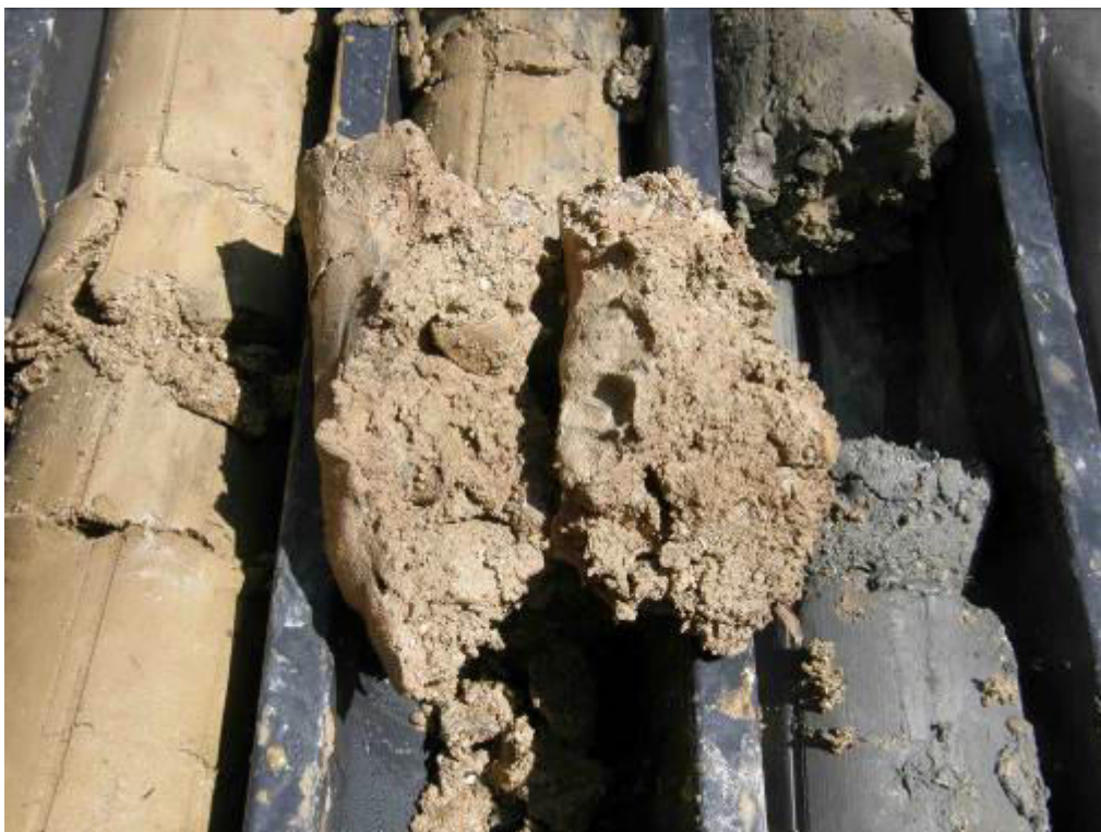
Foto 1. Depositi alluvionali dell'Elsa qui costituiti da Sabbie limose con ciottoli (riferimento sondaggio S2)
