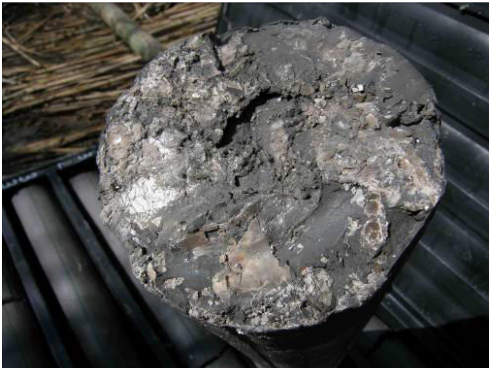
Foto 2 Argille plioceniche sovraconsolidate di colore grigio ricche in frammenti conchigliari (riferimento: sondaggio S2)
