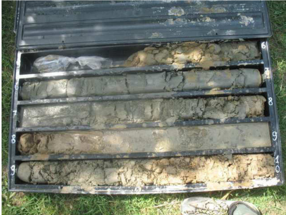
Sondaggio S5, cassetta n.2 (5,00-10,00 metri)
