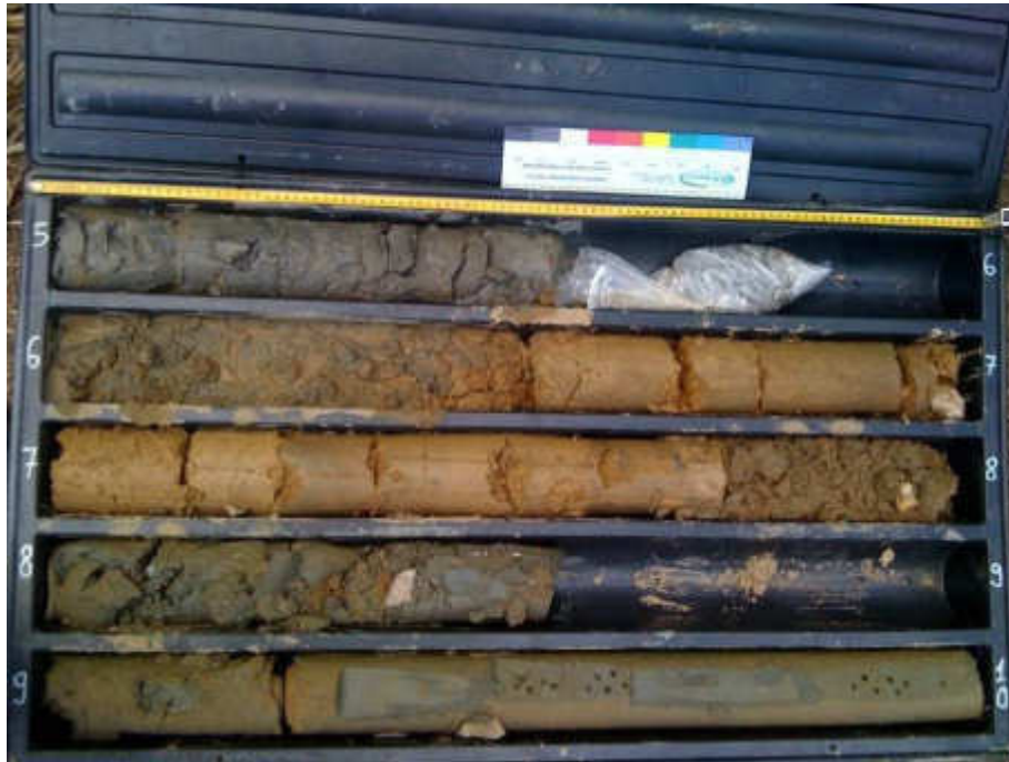
Sondaggio S2, cassetta n.2 (5,00-10,00 metri)
