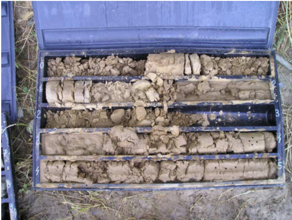
Sondaggio S1, cassetta n.1 (0,00-5,00 metri)
