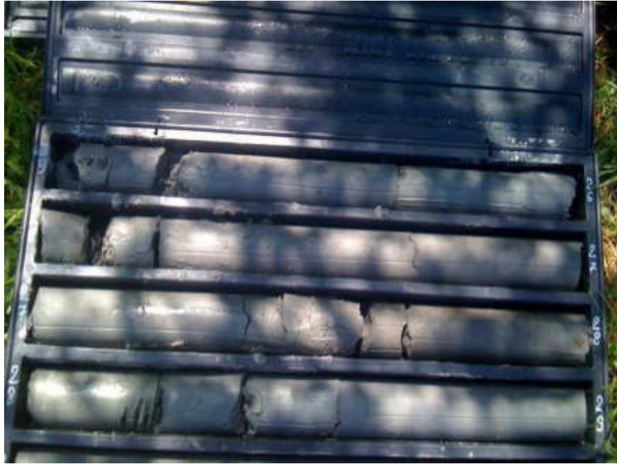
Sondaggio S4, cassetta n.6 (25,00-30,00 metri)
