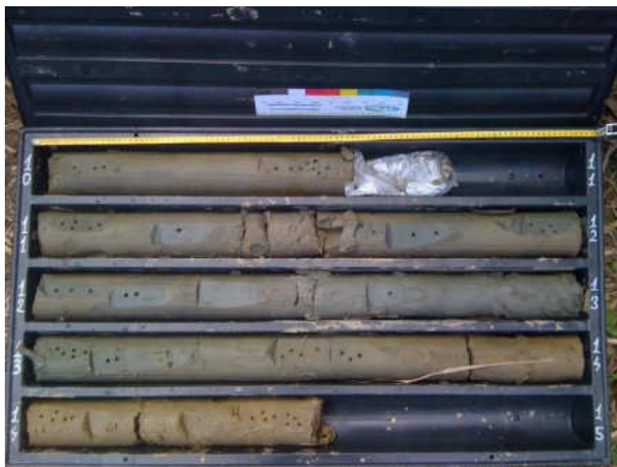
Sondaggio S2, cassetta n.3 (10,00-15,00 metri)
