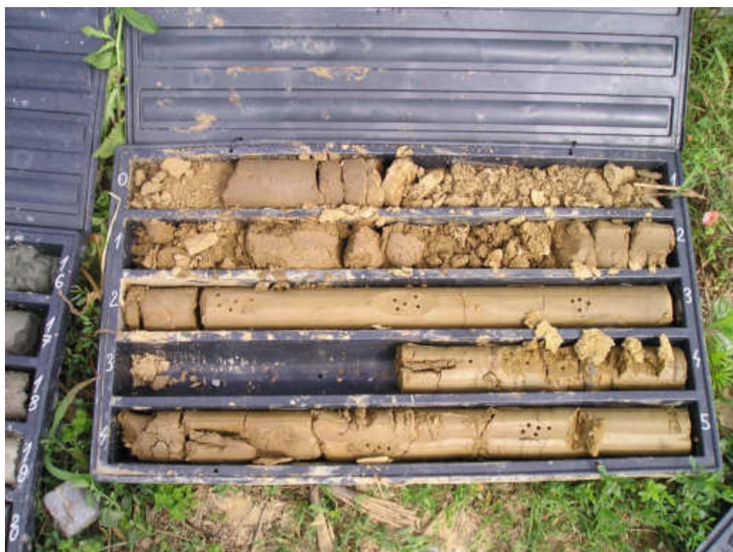
Sondaggio S6, cassetta n.1 (0,00-5,00 metri)
