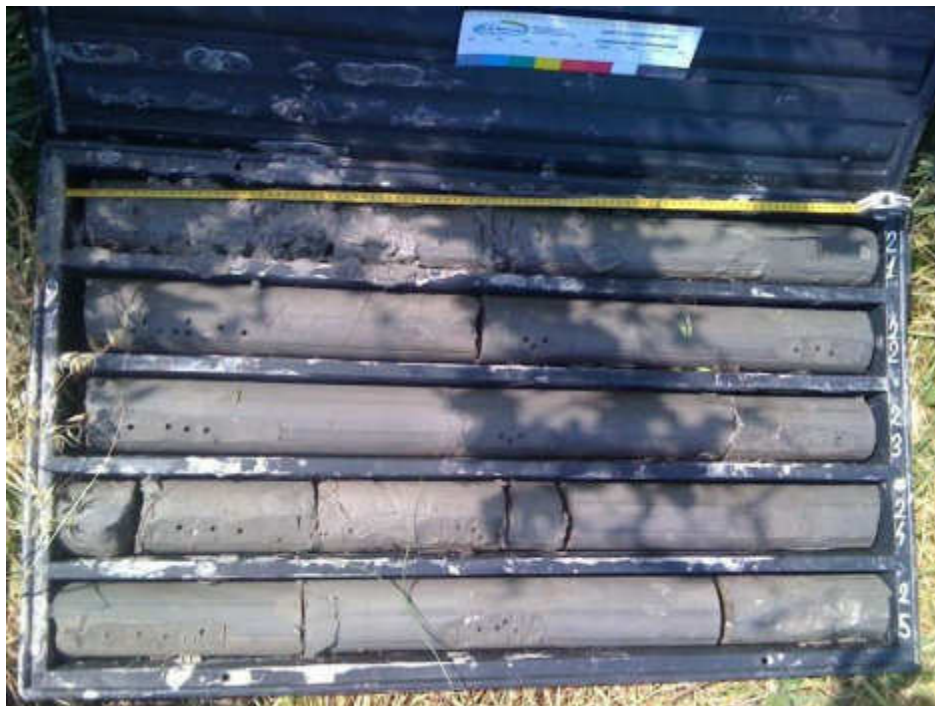
Sondaggio S3bis, cassetta n.5 (20,00-25,00 metri)
