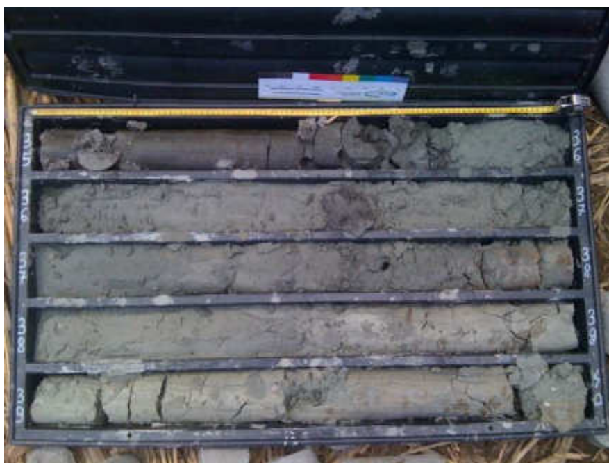
Sondaggio S2, cassetta n.8 (35,00-40,00 metri)
