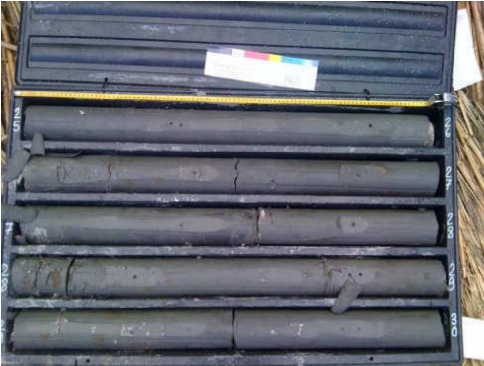
Sondaggio S2, cassetta n.6 (25,00-30,00 metri)
