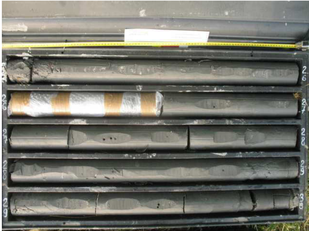
Sondaggio S1, cassetta n.6 (25,00-30,00 metri)
