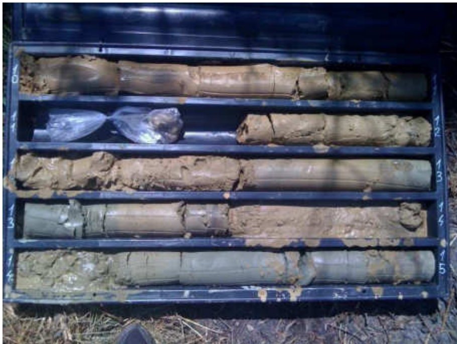
Sondaggio S4, cassetta n.3 (10,00-15,00 metri)
