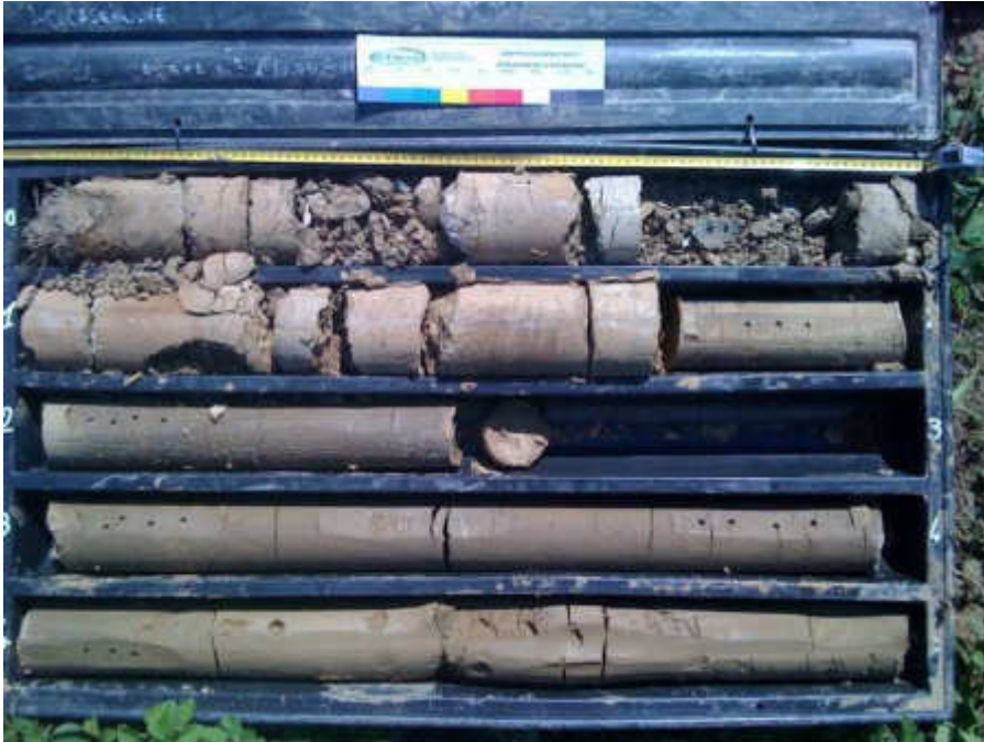
Sondaggio S3, cassetta n.1 (0,00-5,00 metri)
