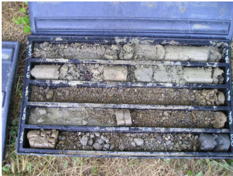
Sondaggio S1, cassetta n.4 (15,00-20,00 metri)
