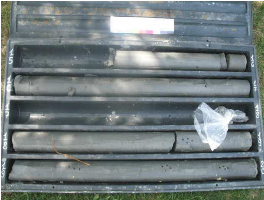
Sondaggio S5, cassetta n.4 (15,00-20,00 metri)
