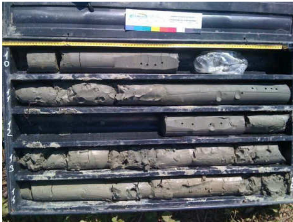
Sondaggio S3, cassetta n.3 (10,00-15,00 metri)
