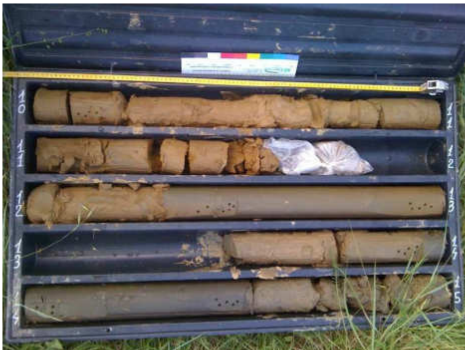
Sondaggio S3bis, cassetta n.3 (10,00-15,00 metri)
