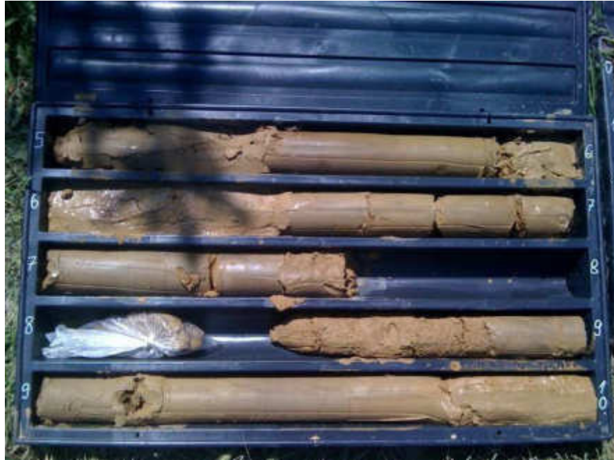
Sondaggio S4, cassetta n.2 (5,00-10,00 metri)
