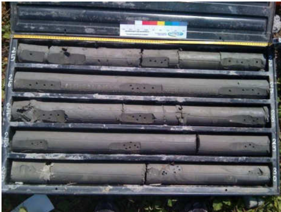
Sondaggio S3, cassetta n.6 (25,00-30,00 metri)
