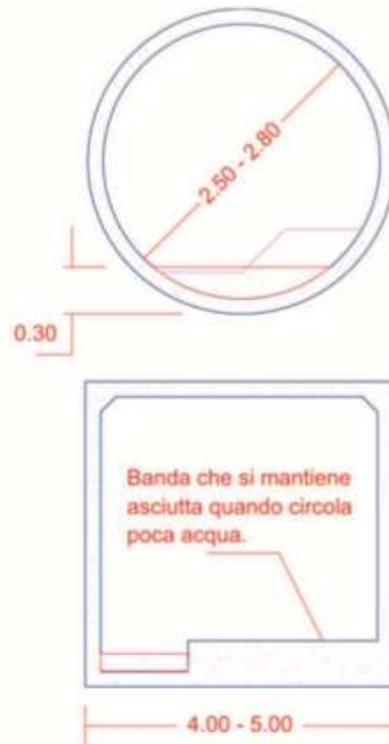
Figura 3 Adattamento di tombini di drenaggio e scatoletti idraulici per il passaggio della fauna (tratto da Rivella – UTET Scienze Tecniche).
